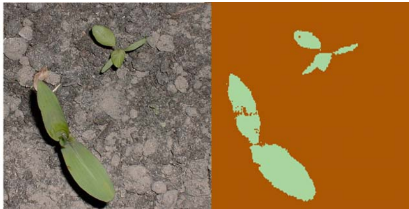
Abb. 6: ImSpector-Analyse (rechts) mit einer Software (Spektralauswertung und Schwellwert ) zur Boden-Pflanze-Unterscheidung (RUCKELSHAUSEN et al. 2004).
