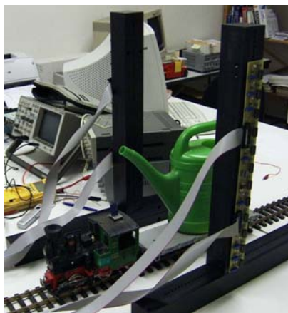
Abb. 4: Testaufbau eines HPS-HR-Lichtvorhangs (links) mit Messergebnis (rechts)
