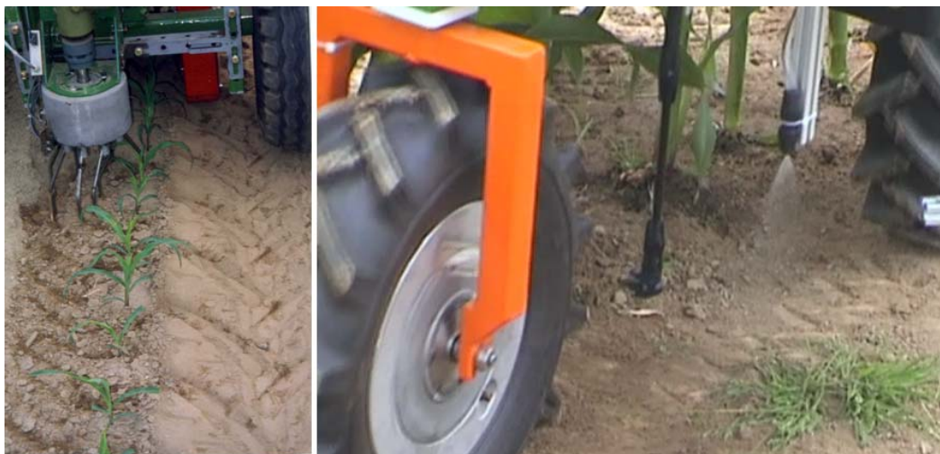
Bild 6: Einzelpflanzenbasierte Unkrautregulierung: mechanische Querhacke (links, [18,19]) und autonomer Sprayroboter Weedy (rechts, [20]).
