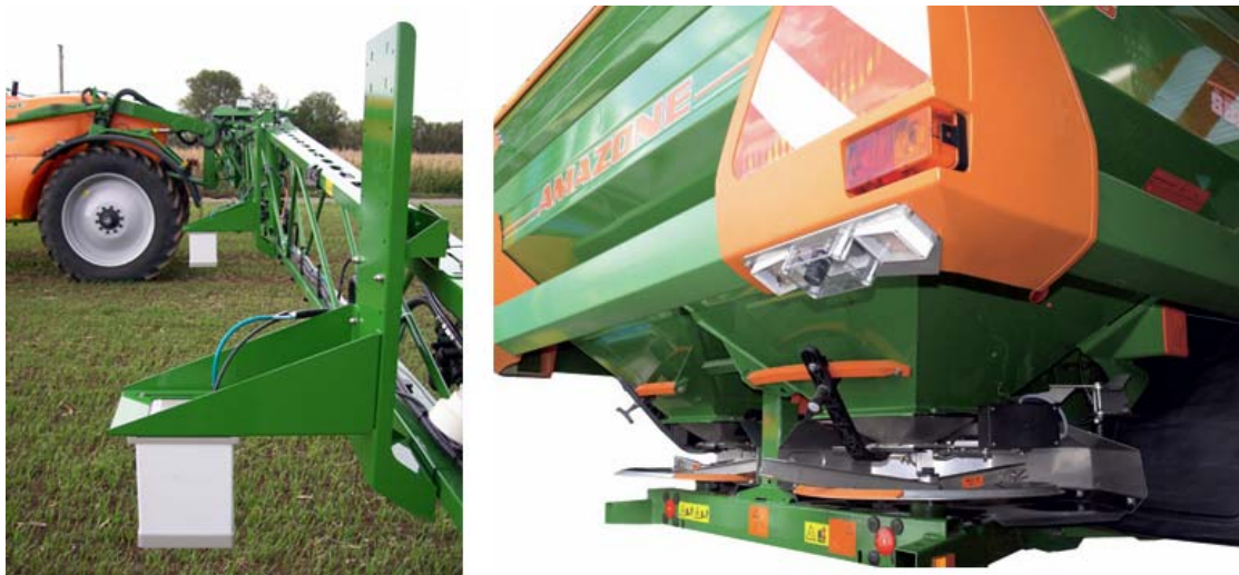
Bild 2: Entwicklungsprojekte zur kamerabasierten Unkrautregulierung (links: „H-Sensor“, [7]) und kamerabasierter Abtastung der Streufächer von Zentrifugalstreuern zur automatischen Ermittlung der Einstellwerte für die Querverteilung (rechts: Argus, [8]).
