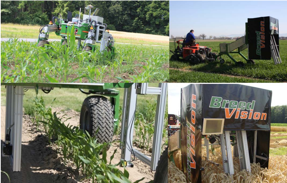
Bild 3: Phänotypisierungsplattformen BoniRob (linke Seite) und BreedVision (rechte Seite) in Feldversuchen [10,11,12].
