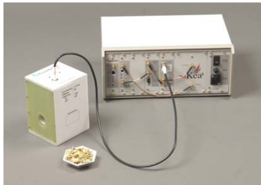
Abbildung 1: Realisierter NMR-Agro-Sensor bestehend aus Messspule und Kea ® -Spektrometer. Die Proben werden in einem Probenröhrchen von 115 mm x 30 mm der Messspule zugeführt.
